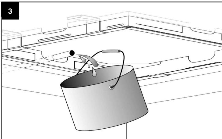
**Montagehinweis:** Beachten Sie die Rahmengrößen auf Seite 7. Bei nachträglicher Montage gelten die angegebenen Ausschnittmaße. In diesem Fall, ist der Spalt zwischen Ausschnitt und Rahmen bauseits zu verschließen. Beim Einbau in eine Massivdecke die Haltetaschen des Einbaurahmens entfernen.
